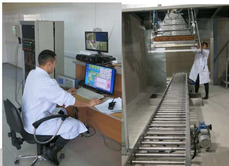
2 Сурет – а) радиациялық өңдеу процесінің негізгі параметрлерін бақылау жүйесі; б) өңделген өнімді сәулелену аймағына тасымалдауға арналған КРП КЗ көлік желісі
